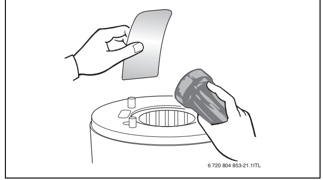
Res. 27 Isı bloğunun atık bakımından kontrolü
